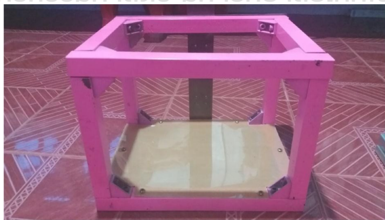
รูปที่ 2 โครงสร้างของห้องจำลองสำหรับผู้โดยสาร
