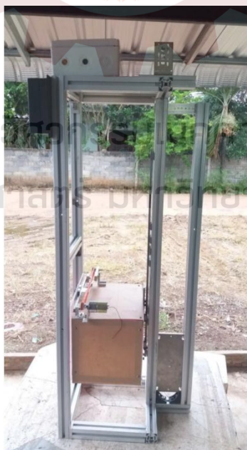
รูปที่ 8 รูปด้านข้างของแบบจำลองลิฟท์สำหรับใช้ในบ้าน 2 ชั้น
